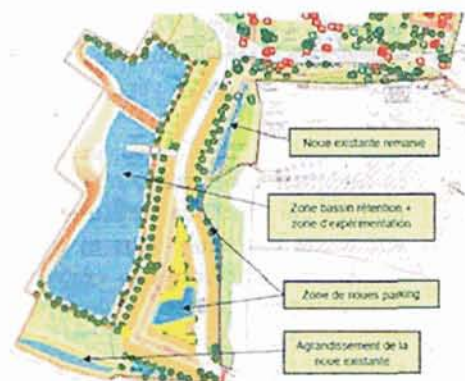
Gestion des eaux pluviales sur le campus, CNRS
